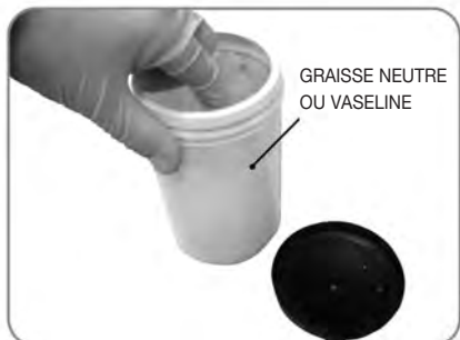
Utilisez de la graisse neutre ou de la vaseline
