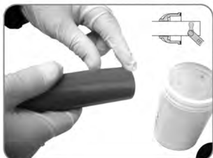
Graisser la partie extérieure du tube
