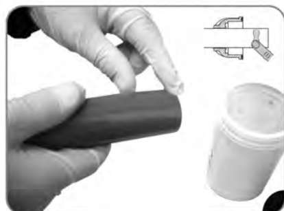
Lubrifique a parte externa do tubo
